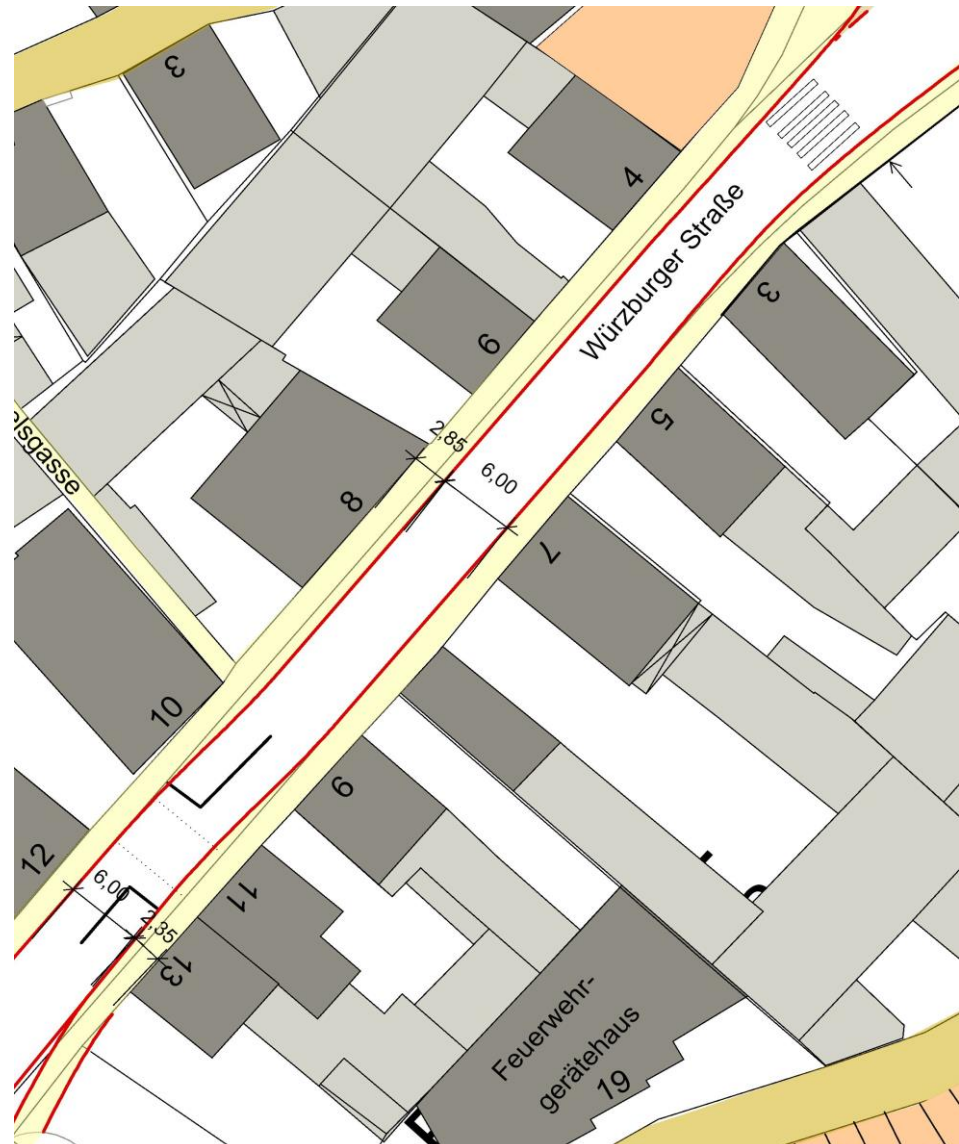
Abbildung 41: Gehwegverbreiterung Würzburger Straße
