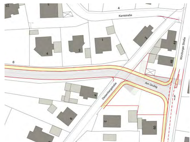
Gestaltungsvorschlag aus der Verkehrsuntersuchung Güntersleben: Neutrassierung Am Grubig - Würzburger Straße (Link, Stuttgart)
