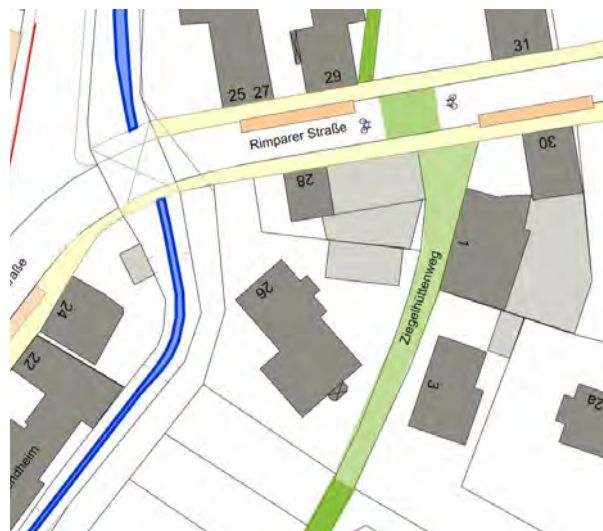
Vorschlag aus der Verkehrsuntersuchung Güntersleben: farbige Markierung der Querung und Umorganisation der Stellplätze (Link, Stuttgart)
